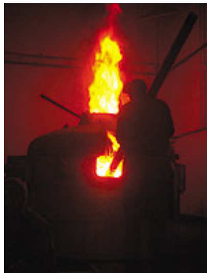
Mit langen Stangen prüfen die Glockengießer ein letztes Mal das Schmelzgut (Foto: ka-news)
