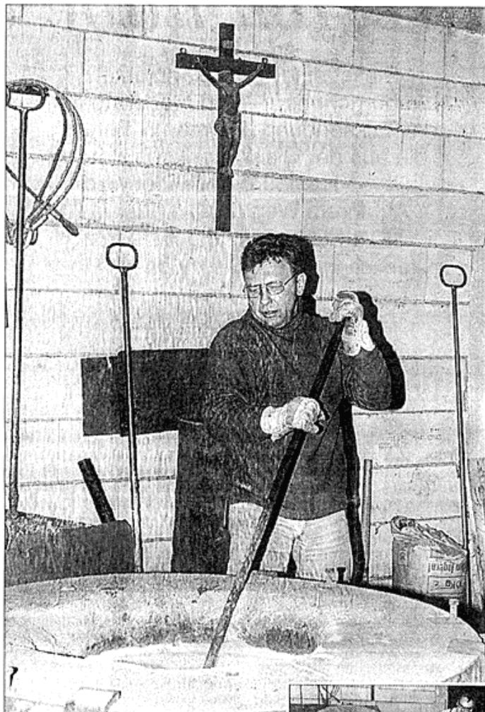
Kuno Hänsel am Schmelzofen. In diesem Ofen wird die Bronze für die Michelglocke geschmolzen. Fotos: BODIG
